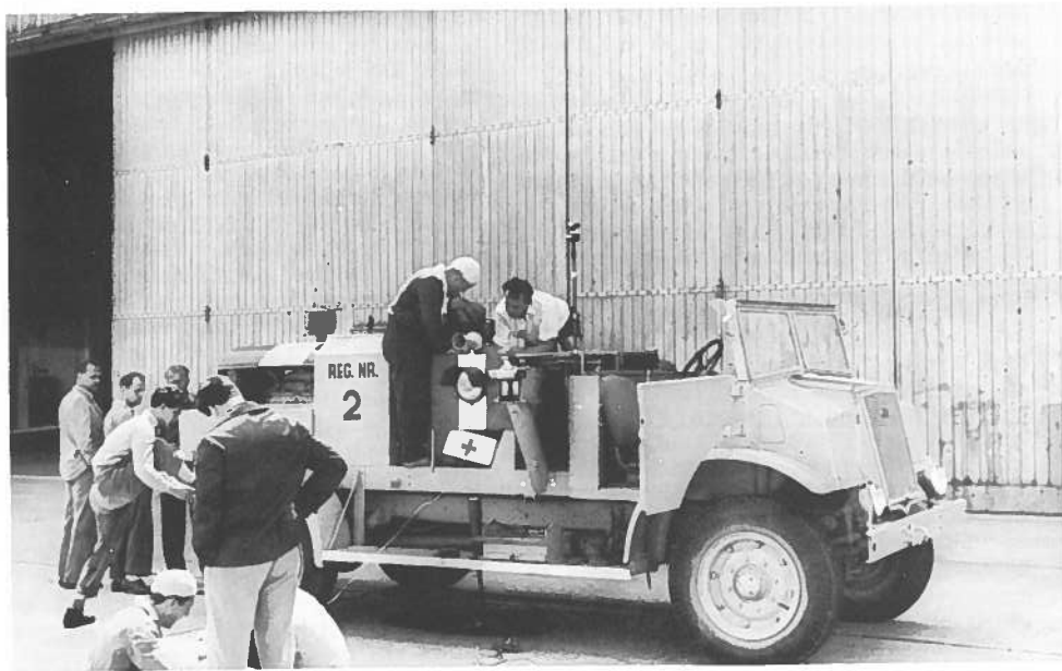
Die neue Schleppwinde wird vom Bauprüfer Edi Kirchwegger kritisch unter die Lupe genommen
