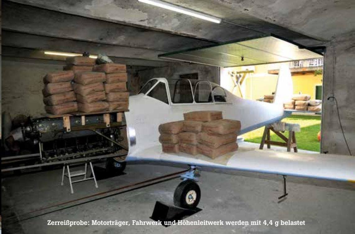
Zerreiprobe: Motortrger, Fahrwerk und Hhenleitwerk werden mit 4,4 g belastet
