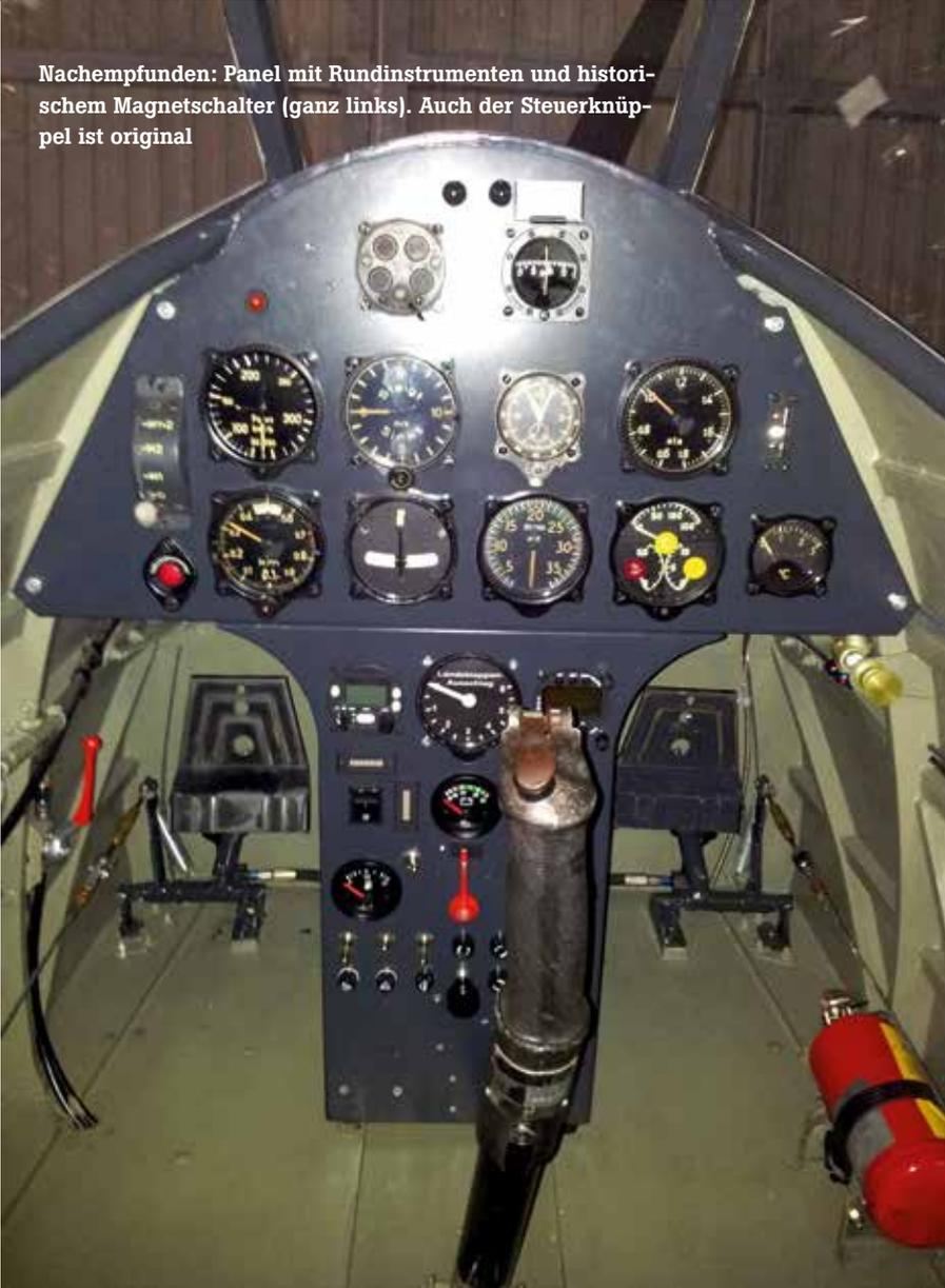
Nachempfunden: Panel mit Rundinstrumenten und historischem Magnetschalter (ganz links). Auch der Steuerknppel ist original
